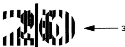
Les caractéristiques 6 et 7 de la revendication 1 bornent la largeur de lignes à des valeurs inférieures à 31,25  $\mu\text{m}$ . Selon la caractéristique 4, la largeur des lignes de chaque image codée est inférieure ou égale à celle de la trame de révélation (31,25  $\mu\text{m}$ ). L'oeil humain n'étant pas capable de distinguer des détails inférieurs à 200  $\mu\text{m}$ , la visualisation de l'image combinée ne permet pas d'observer les images codées
