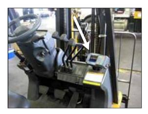
D4, der Pfeil wurde von der Kammer hinzugefügt und zeigt die Position des KEYTROLLER LCD601 an. Erkennbar ist der Hubmast, an dem die Lastgabel befestigt ist
